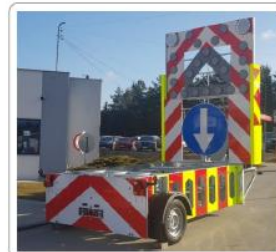
Figura 1. Caracteristici tehnice atenuatoare de impact
